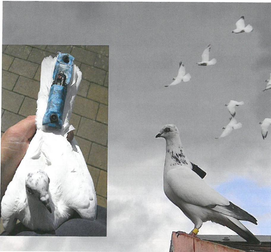
Abbildung 1: Schwanz- und Rückenmontage beim „AltimeterThree“
