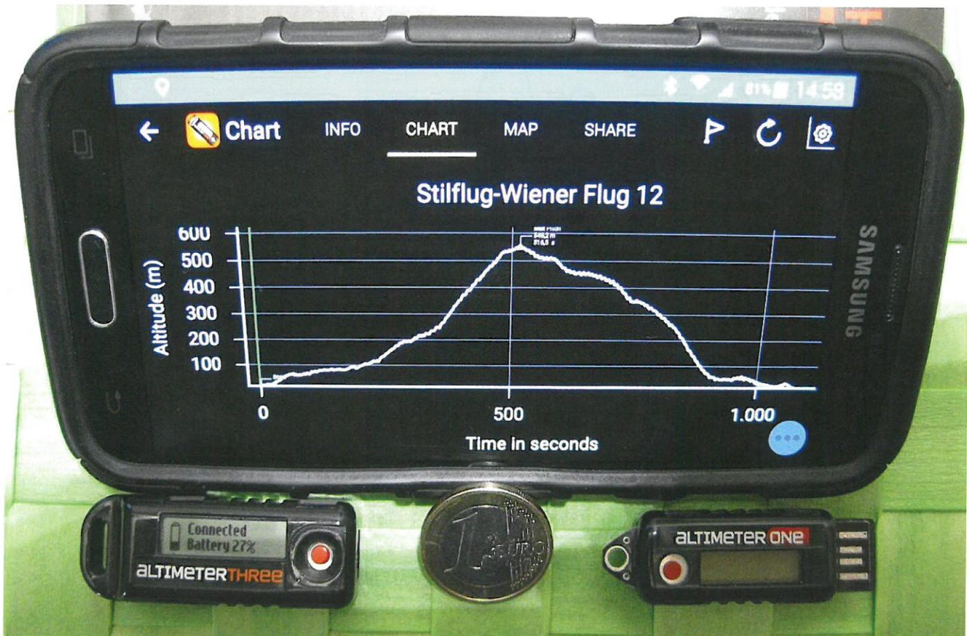
Abbildung 2: „AltimeterThree“ und „AltimeterOne“ mit in der App dargestelltem Flugverlauf
